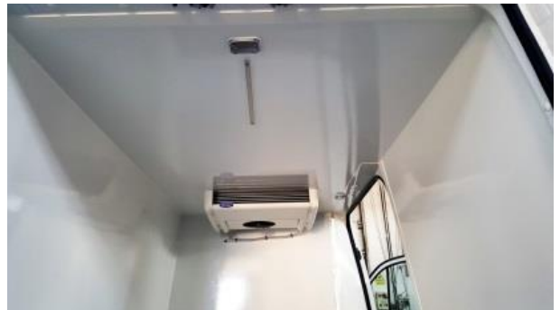
Detail stropu s integrovaným světlem a chladícím agregátem
