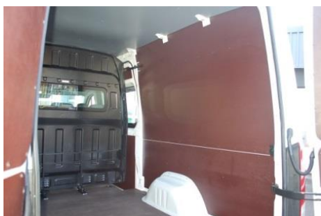
Přepážku lze zafixovat ve dvou pozicích
