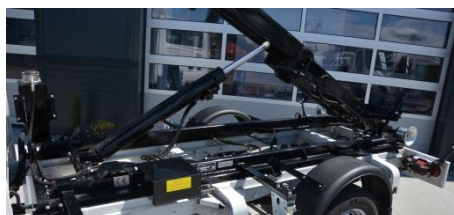
Detail rámové konstrukce a zdvihacího pístu
