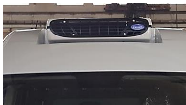
Detail stropu s integrovaným světlem a chladícím agregátem
