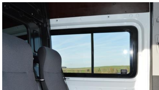
Detail posuvného okna
