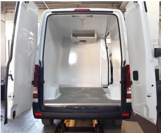
Protiskluzová podlaha s hliníkovými ochrannými lištami
