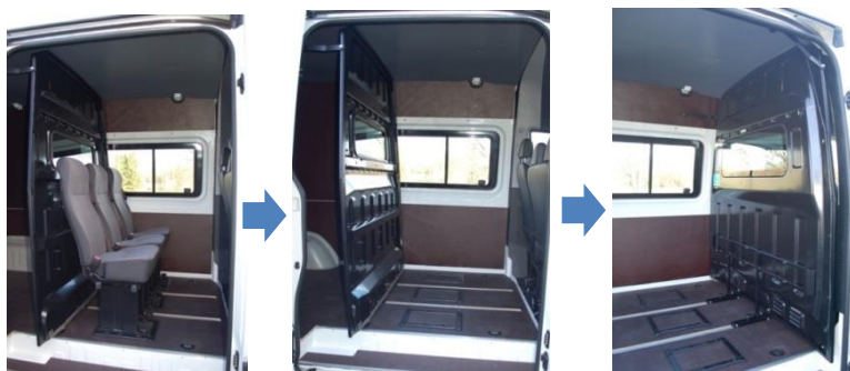
Přepážku lze zafixovat ve dvou pozicích
