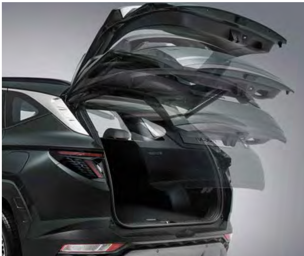
Elektricky ovládané 5. dveře s bezdotykovým ovládním.
