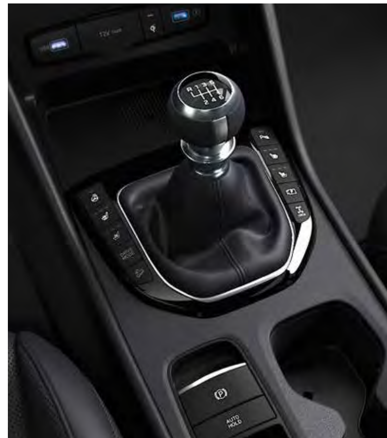
Šestistupňová inteligentní manuální převodovka iMT.
