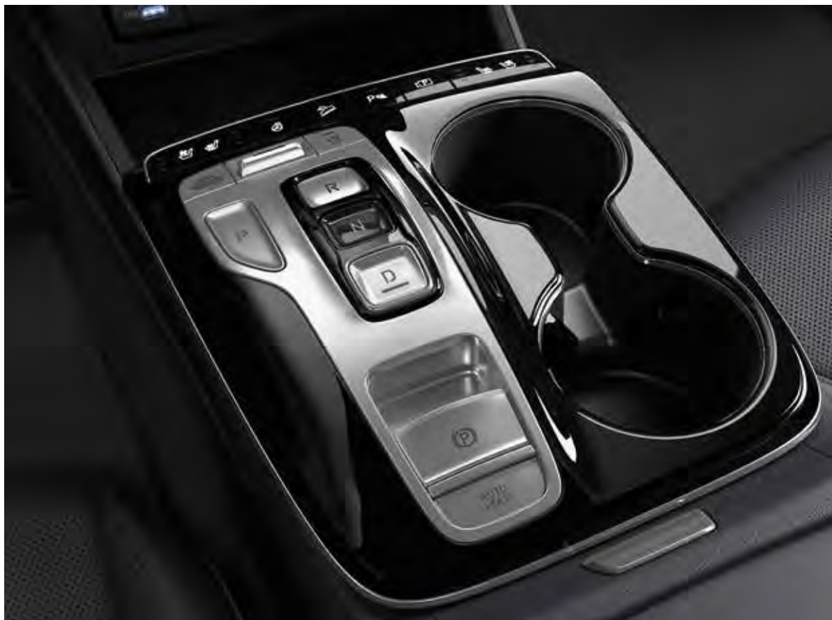
Elektronické ovládání převodovky tlačítka „Shift by Wire“.
