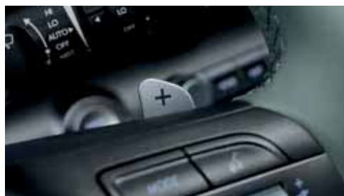
Pádla pod volantem umožňující sekvenční řazení rychlostních stupňů – pro ICE / možnost nastavení rekuperačního brzdění – pouze pro HEV
